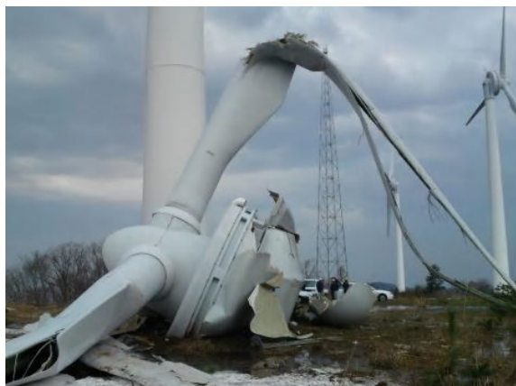
図 4-16 太鼓山風力発電所のナセル落下事故の様子
